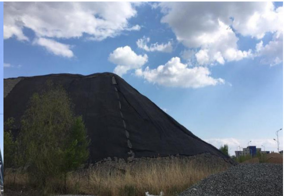
露天料场防尘抑尘网遮盖
