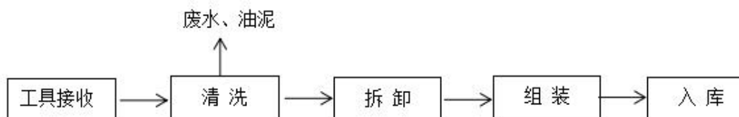
图 2-5 回收井下工具工艺流程图
