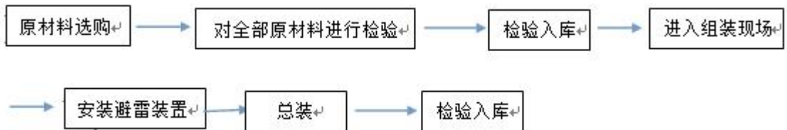
图 2-7 绝缘接头保护器生产工艺流程及产污节点
